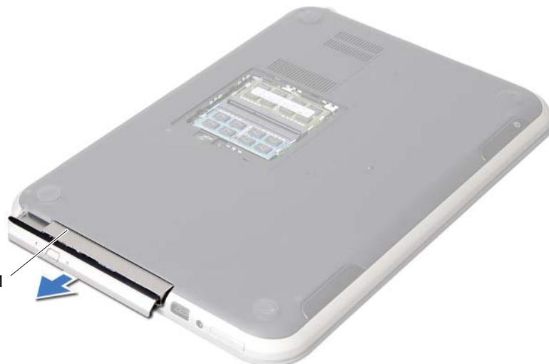
1 sklop optičke disk jedinice
